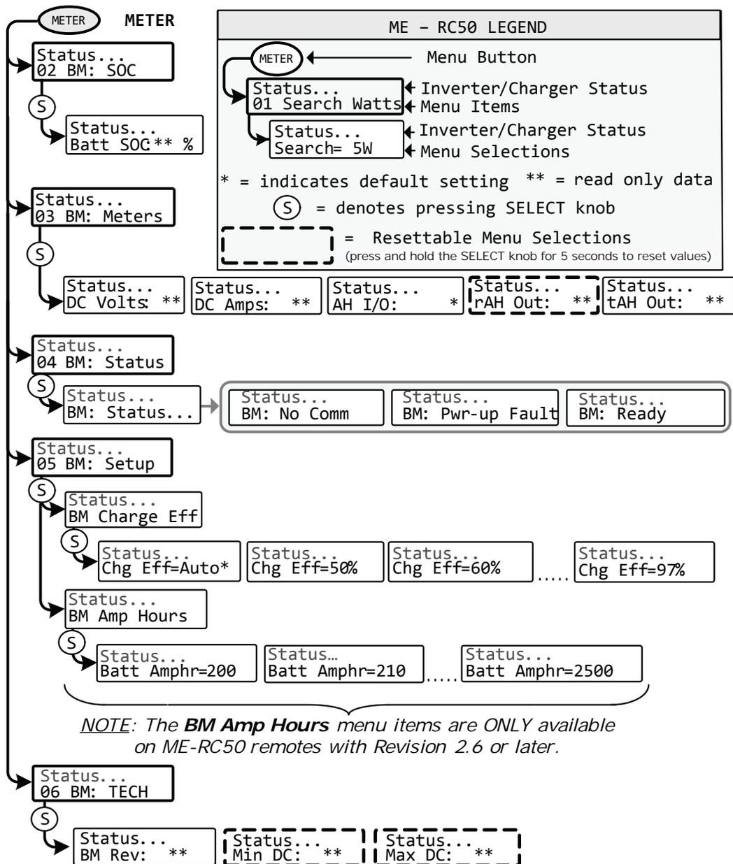
Figure 3-3, ME-RC50 METER Menu Map (Displays w/BMK Settings)
